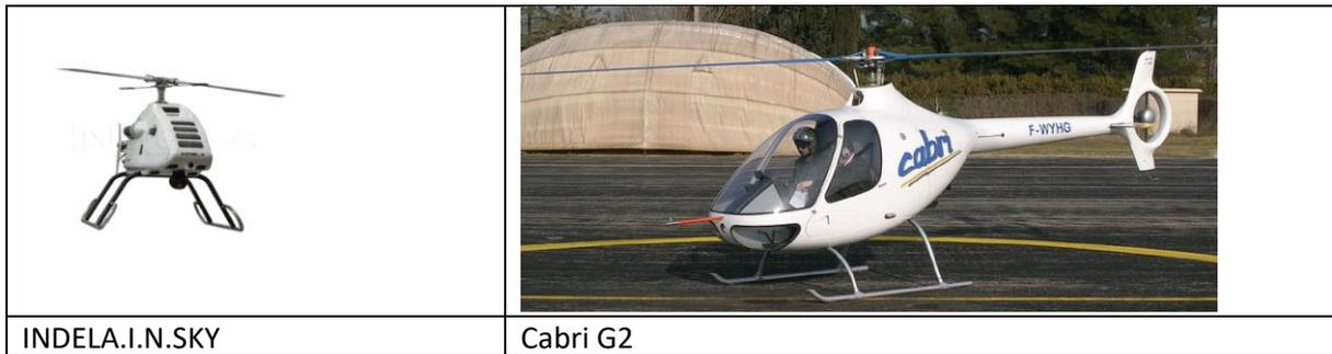
Les deux hélicoptères sont équipés d'une motorisation thermique à piston.
